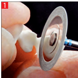
1 Обработка оксид-циркониевой керамики. Trimming of sintered zirconia.
